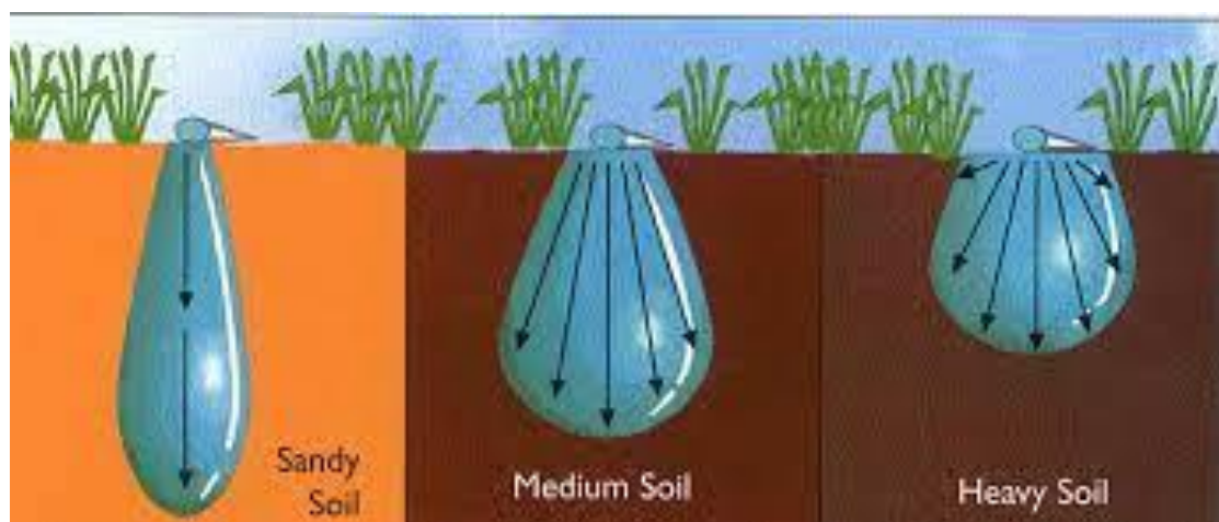
Figure 4.2 : Bulbe humidifié par le goutteur selon le type de sol
