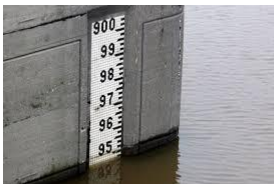
Figure 3.2 : Echelle limnimétrique (source :guide pratique du terrain Aix-Marseille Université 2015)
