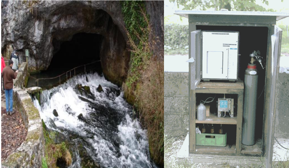
Figure 3.3: limnigraphe à pression:(source:guide pratique du terrain Aix-Marseille Université 2015)
