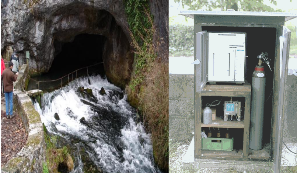
Figure 5.4: limnigraphe à pression.(source:guide pratique du terrain Aix-Marseille Université 2015)
