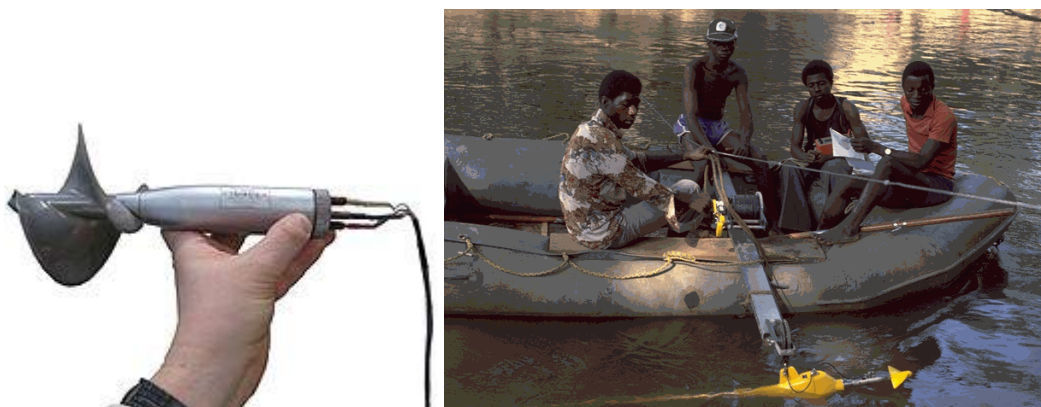
Figure 5.6 : jaugeage au moulinet à l'aide d'un bateau (Source : wikipedia2016).
