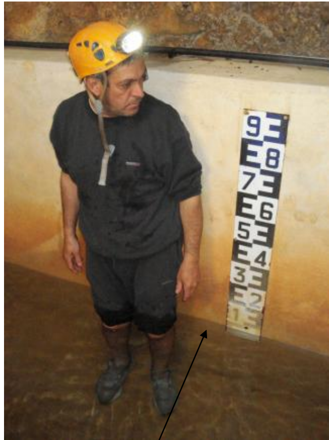
Figure 5.2 : Echelle limnimétrique (source :guide pratique du terrain Aix-Marseille Université 2015)
