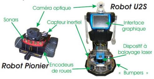
**Fig.1.1** – Capteurs typiques d'un robot.
