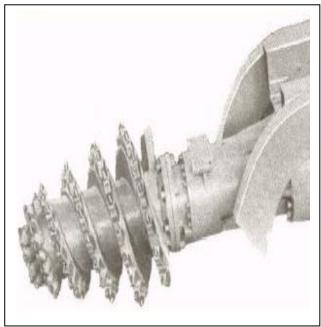
Fig.2 : Bras à attaque radiale
