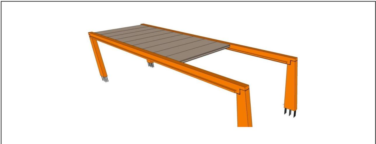
**Figure 58: Assemblage Plancher-Poutre**
