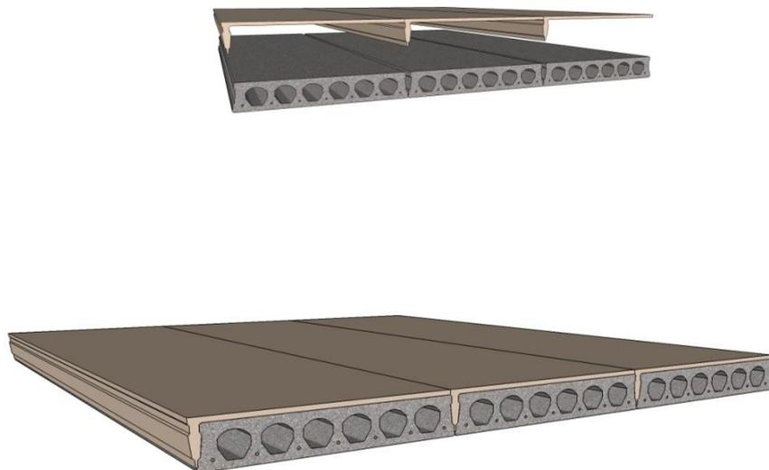
**Figure 45: Plancher en dalles alvéolées avec étanchéité posé sur site**
