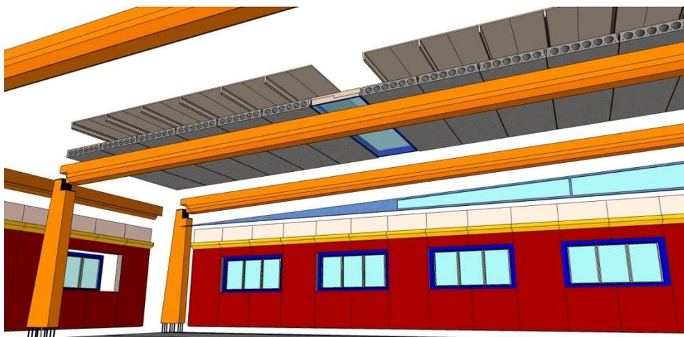
**Figure 80 : Détail des éléments du système en vue intérieure éclatée**
