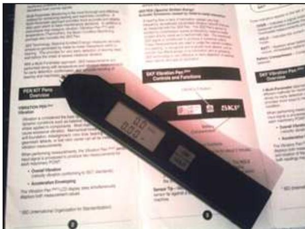
Figure III.2 : Photographie du vibromètre.
