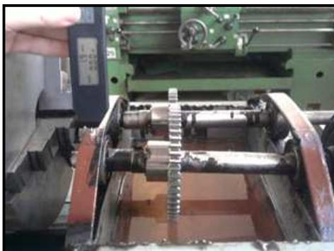
Figure III.3 : Mesure de la vitesse de vibration.
