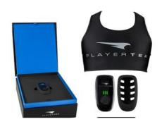
يقوم هذا الجهاز باستخدام خاصية"حساس السرعة وحساس مغناطيسي ونظام تحديد المواقع العالمي"، من أجل قياس حالة اللياقة البدنية للاعب خلال التدريب أو المباريات، حيث يعمل على حساب المسافة التي قام اللاعب بانجازها، والسرعة القصوى التي وصل لها اللاعب وعدد المرات التي وصل بها لسرعته القصوى، وذلك بجانب قياس ضربات القلب ومجهود اللاعب مما يجعل المدرب البدني يقيس الحالة البدنية لكل لاعب بشكل منفرد.
