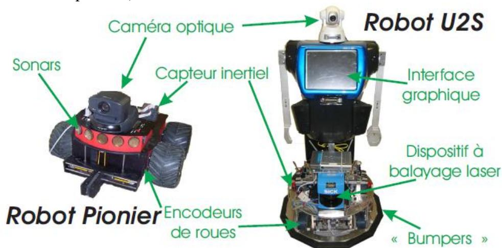
Fig.1.1 – Capteurs typiques d'un robot.
