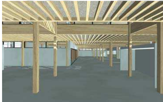
Figure I. 13: Perspective intérieure d'une ossature bois.(certu,2008).
