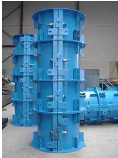
Photo I.26: Coffrage métallique pour poteau. ( www.bouygues-construction.com )
