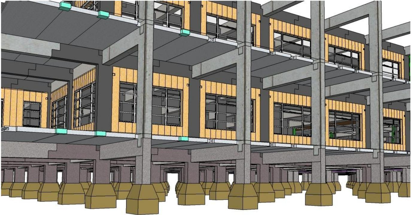
**Figure 102: Exemple d'assemblage poteau, poutre , dalle et cloison en beton**
