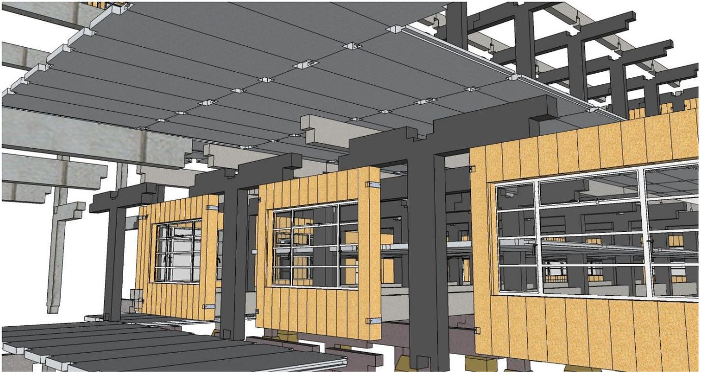
**Figure 101: Exemple d'assemblage poteau, poutre , dalle et cloison en beton**
