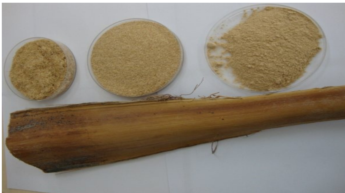
Photo 1: Aspects de la tige de dattes et des tailles de grains obtenus par broyage et tamisage
