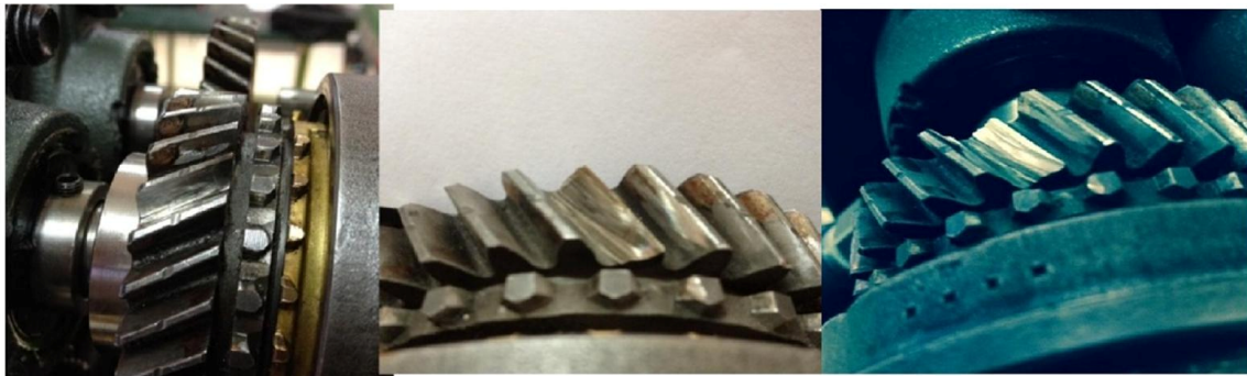
Fig. IV.29. Les trois niveaux de dégradation de la dent.
