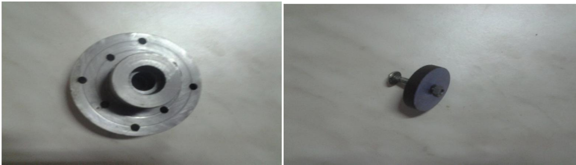
Fig. IV.9. Disque et masse pour engendrer un balourd.
