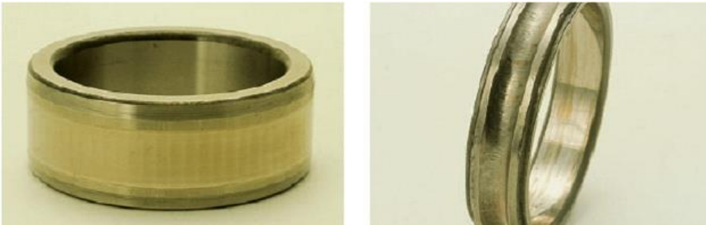
Figure II.6 Corrosion sur une piste de roulement [32].
