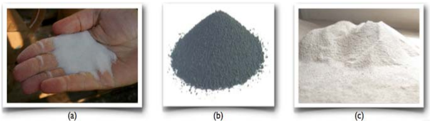
Figure II.11 : Exemples de charges utilisées dans les CMO : (a) micro-billes de verre, (b) noir de carbone, (c) silice.
