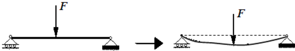
Figure.III.2: Courbure d'une poutre.
