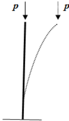
Figure III.1 Perte de stabilité d'une barre comprimée axialement [25]
